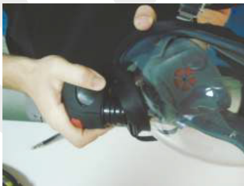
Figura 12 – Montagem do regulador de segundo estágio com a peça facial
