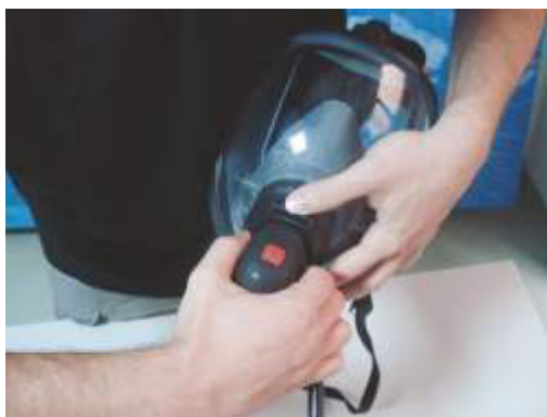
Figura 6 – Desconectando o regulador de segundo estágio da peça facial
