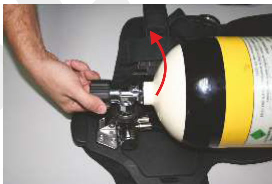
Figura 8 – Abrindo a válvula do cilindro
