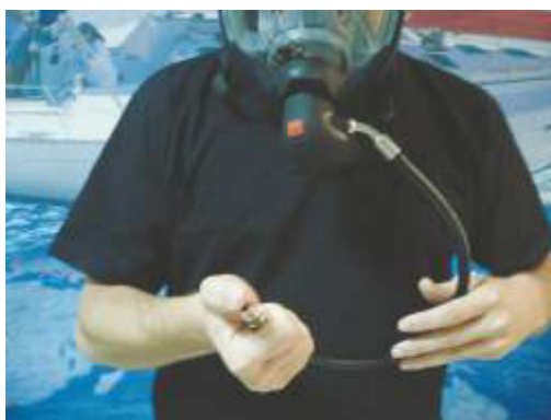
Figura 13 – Teste de estanqueidade da peça facial
