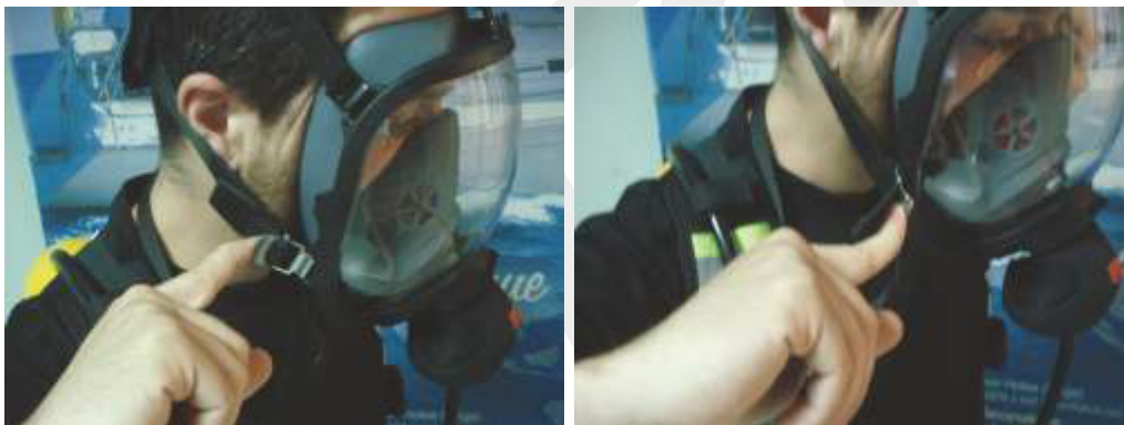
Figura 22 Solte as tiras de borracha e retire a proteção facial.
