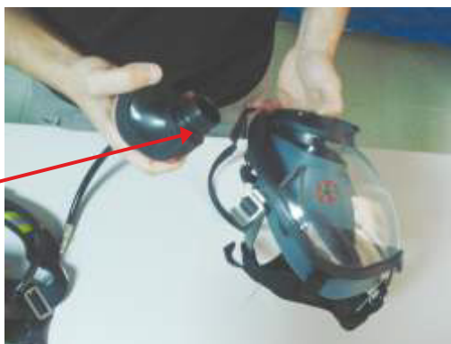
Figura 11. Verificação visual do redutor de segundo estágio e da máscara facial.
